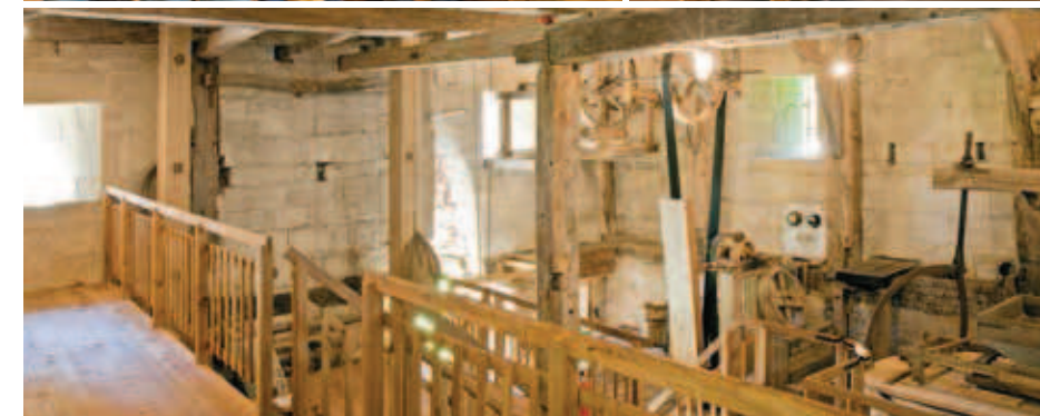
Lange hatte es sich bei der Anlage im Stevertal um eine Doppelmühle gehandelt, denn neben der Getreidemühle lag früher eine Ölmühle, von der aber nur noch Fundamentreste übrig sind. Schon 1928 wurde die Wasserkraftnutzung auf eine Turbine umgestellt. Sie treibt heute wieder ein funktionsfähiges Mahlwerk an und liefert überdies Strom.
